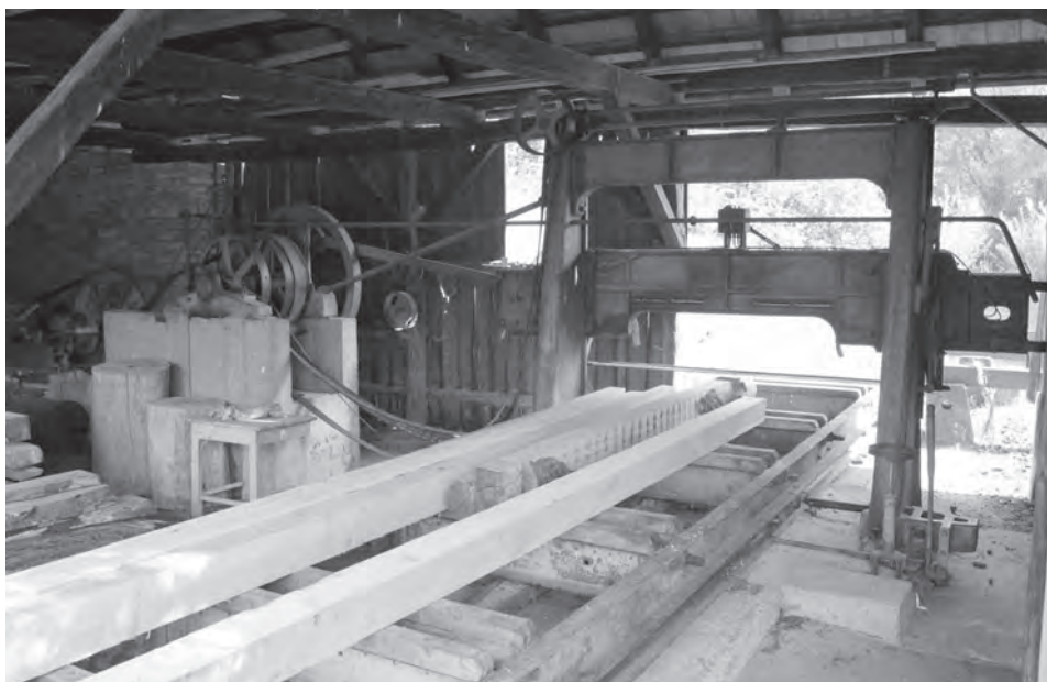
Obr. 2. Vnitřní zařízení jednorázové horizontální pily. Muzeum vesnice jihovýchodní Moravy. Foto M. Novotný, 2014 Pic. 2. Interior of the single-leaf horizontal sawmill. Museum of the Villages of South-East Moravia. Photo M. Novotný, 2014
